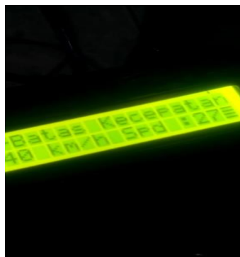
Gambar 7. Pengujian pembatas pada kecepatan 40 km/jam
