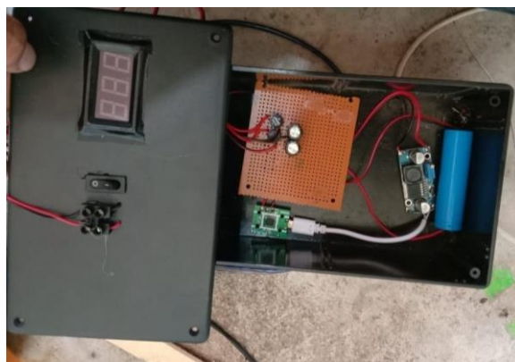
Gambar 5. Rangkaian Lengkap Sistem Pemanen Energi Tenaga Gerak
