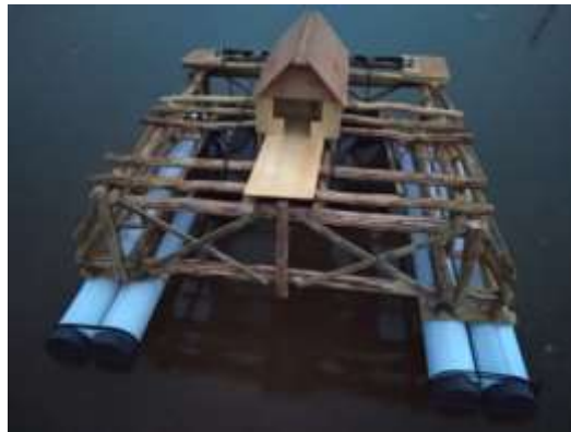
Gambar 4. Pengujian pelampung pada bagan apung
