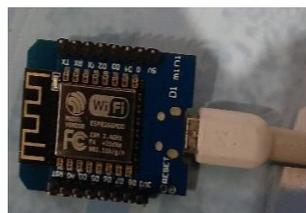
Gambar 2. Pengujian ESP8266
