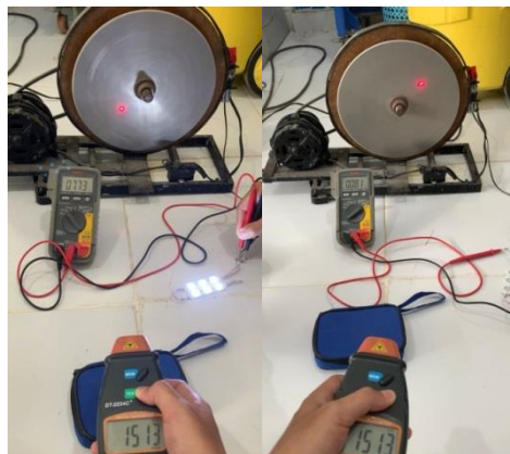
Gambar 2. Pengukuran Tegangan dan Arus saat diberi beban lampu led 12 Volt.
