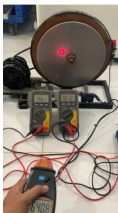
Gambar 1. Pengukuran tegangan generator
