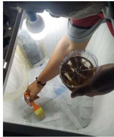
(a) (b) Gambar 5. a) Perubahan Alas Tabung, b) Peresinan
