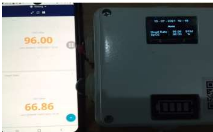
Gambar 6. Tampilan pada layar OLED dan tampilan pada dashboard ubidot.
