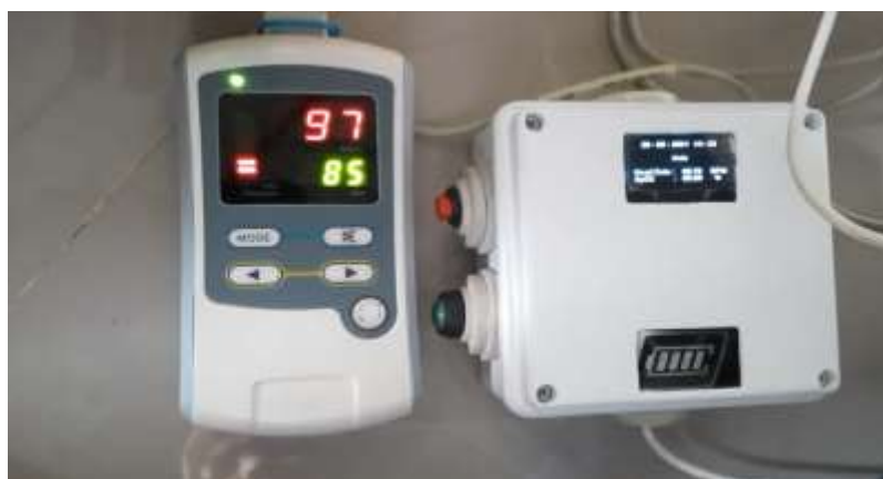
Gambar. 3 Pengujian alat dibandingkan dengan pulse oximetry milik rumah sakit.
