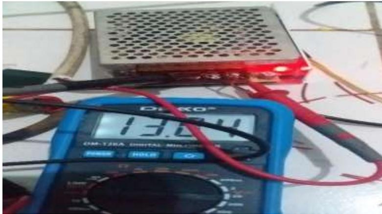
Gambar 3. Pengujian adaptor 12 Volt
